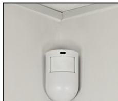
Instalação de ângulo Utilizar apenas a base do DG12
