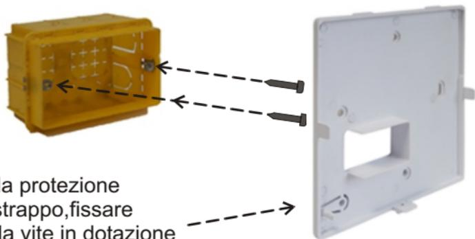
Per la protezione antistrappo, fissare con la vite in dotazione
