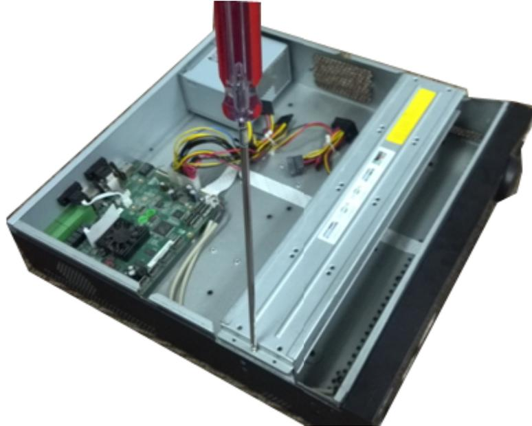
Passo 2 Togliere la parte inferiore del supporto dell'HDD e del supporto del CD-ROM.
