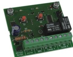
Le DX20 est un découdre bicanal pour l'antenne avec récepteur BIRD doté de deux relais en sortie pilotés des deux touches (canaux A et B) de radiocommande TWIN.
