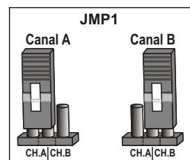
Ainsi, la cellule photo Transmission 1, même si elle illumine le récepteur Réception 2, n'est jamais alignée car Tx1 et Rx 2 ont été configurés sur des canaux de fonctionnement différents.
