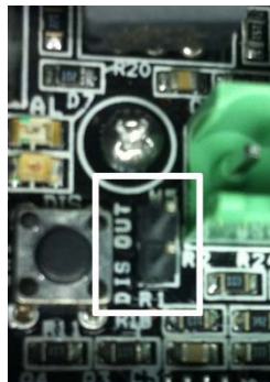
2. Collegarsi all'uscita DIS OUT ( open collector negativo ) per riportare la segnalazione con il cavetto in dotazione.
