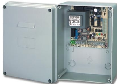
La PCM1 es una centralita de automación para persianas, y funciona sólo con motorreductores dotados de final de corsa, ya que son útiles al procesador para establecer la lógica de funcionamiento, los tiempos y las direcciones de apertura y cerradura.
