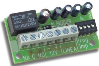
L' SCHSW es una placa electrónica contaimpulsions de conectar a una serie de contactos "switch" para persianas, o a una serie de contactos a vibración.
