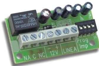
L'SCHSW est une fiche électronique compteimpulsions à connecter à une série de contacts "switch" pour rideaux, ou à une série de contacts à vibration.
