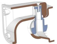
Inserire il cavo, facendolo passare all'interno dello snodo.
